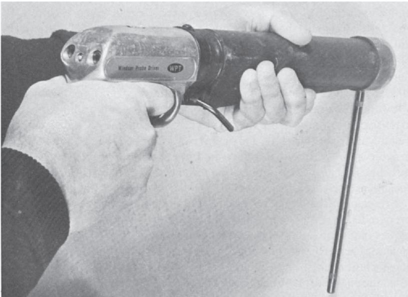
Fig. 2.11. Windsor probe test.
