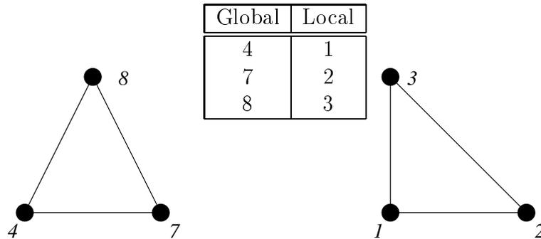
$$\mathbf{K}_e = \begin{bmatrix} k_{11}^e & k_{12}^e & k_{13}^e \\ k_{21}^e & k_{22}^e & k_{23}^e \\ k_{31}^e & k_{32}^e & k_{33}^e \end{bmatrix} \quad \mathbf{f}_e = \begin{bmatrix} f_1^e \\ f_2^e \\ f_3^e \end{bmatrix}$$
